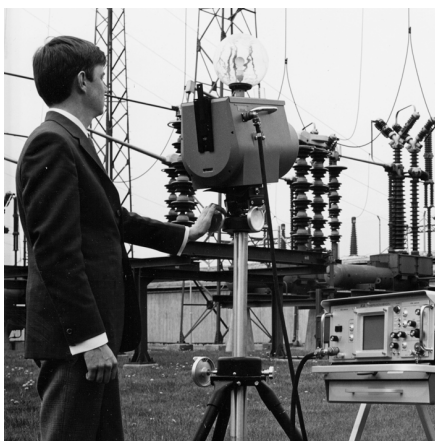
Figura 14.2 1969: Thermovision Modelo 661. A câmara pesava cerca de 25 kg, o osciloscópio 20 kg e o tripé 15 kg. O operador necessitava ainda de um conjunto de geradores de 220 VCA e de um recipiente de 10 litros de azoto líquido. À esquerda do osciloscópio, é possível ver-se a ligação à Polaroid (6 kg).
